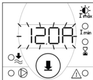
Selecionar o comando. Piscando o sinalizador e o valor.
