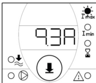
Carregar para confirmar a alteração de valor.
