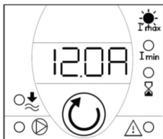
Roda-se e acende o comando "I max". Mostra o valor ajustado.
